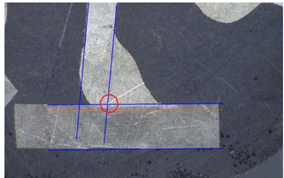
T1とT2の交点にあるスロートの取り付けポイント
