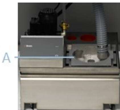
A Statická filtrační jednotka
